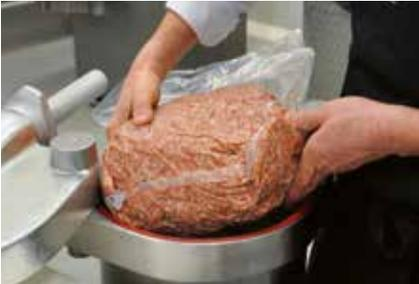
Mettre **immédiatement** dans le pousoir la mêlée encore **emballée sous vide**. Fermer le pousoir et procéder immédiatement au poussage. Pendant le poussage, le sac sous vide se déchire et la mêlée arrive directement dans la canule et par là dans les boyaux.
